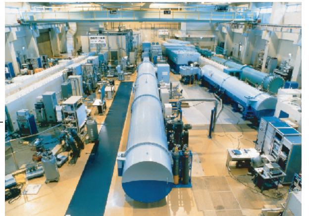
中性子導管で輸送された中性子を利用するガイドホール内の中性子散乱実験装置群
