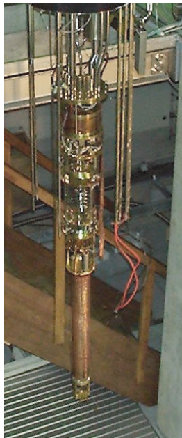
枝断熱消磁法による超低温生成装置。この装置によって10 -8 Kという世界最高水準の超低温が得られる。
