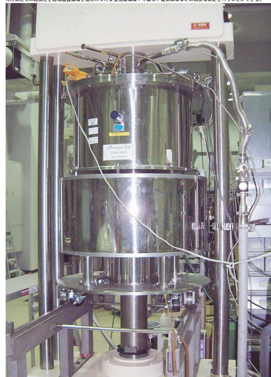
多重極限環境の生成装置 12万気圧もの超高压を超低温強磁場を合わせた多重極限環境下で磁化や電気伝導などの精密な測定を行うことができる。
