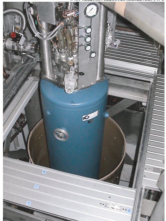
超低温冷凍機回転装置 10 -8 Kという超低温を発生する装置全体を毎秒10回転の速度で回転させている
