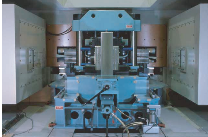
電磁漣縮法の装置 この装置によって600Tを超える超強磁場(実験室内で得られる磁場としては世界最高値)が得られている
