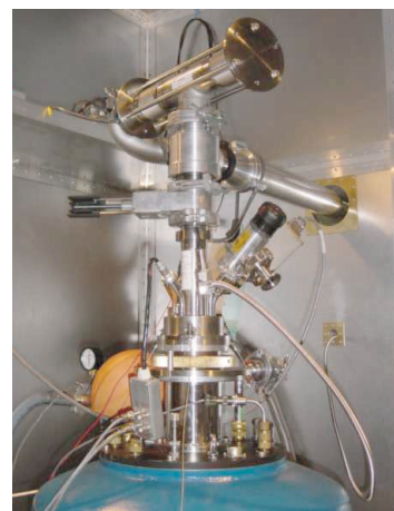
回転磁場下での熱伝導率測定装置とその概念図
